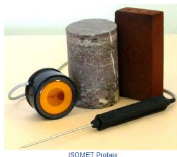
Slika 3.2: Merilnik toplotne prevodnosti http://www.appliedp.com/en/isomet.htm
